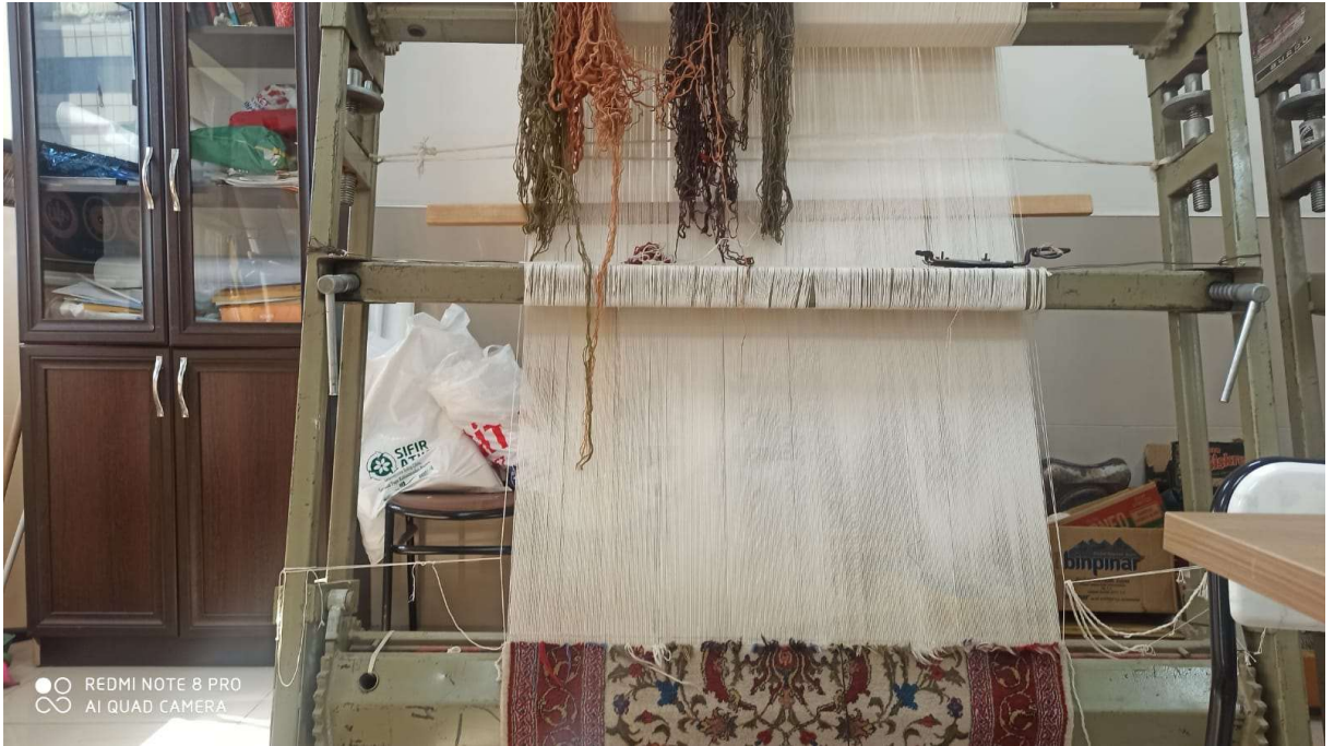
Fotğraf 3: Atölyede Yer Alan Metal Sarma Halı Tezgahında Halı Dokuma Örneği
