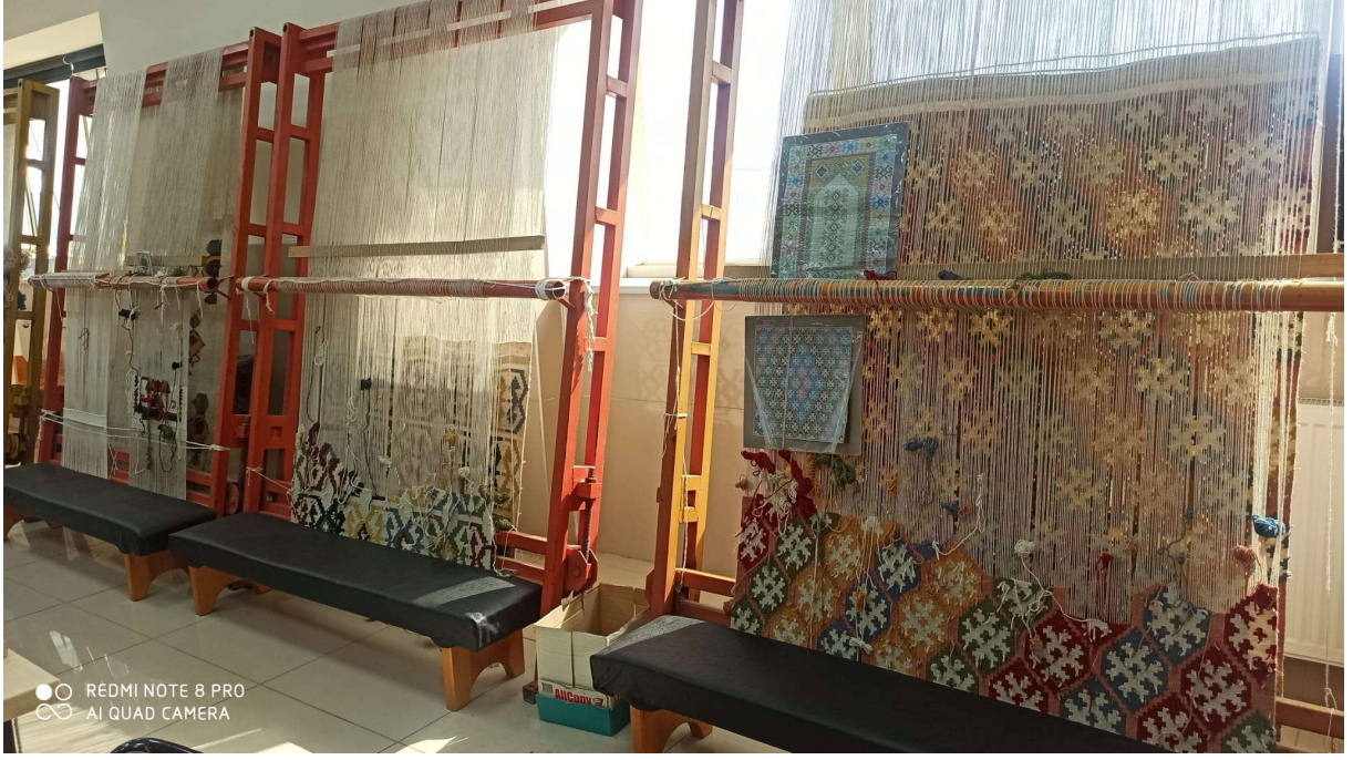
Fotoğraf 2: Atölyede Yer Alan Metal Germe Kilim Tezgahında Kilim Dokuma Örnekleri
